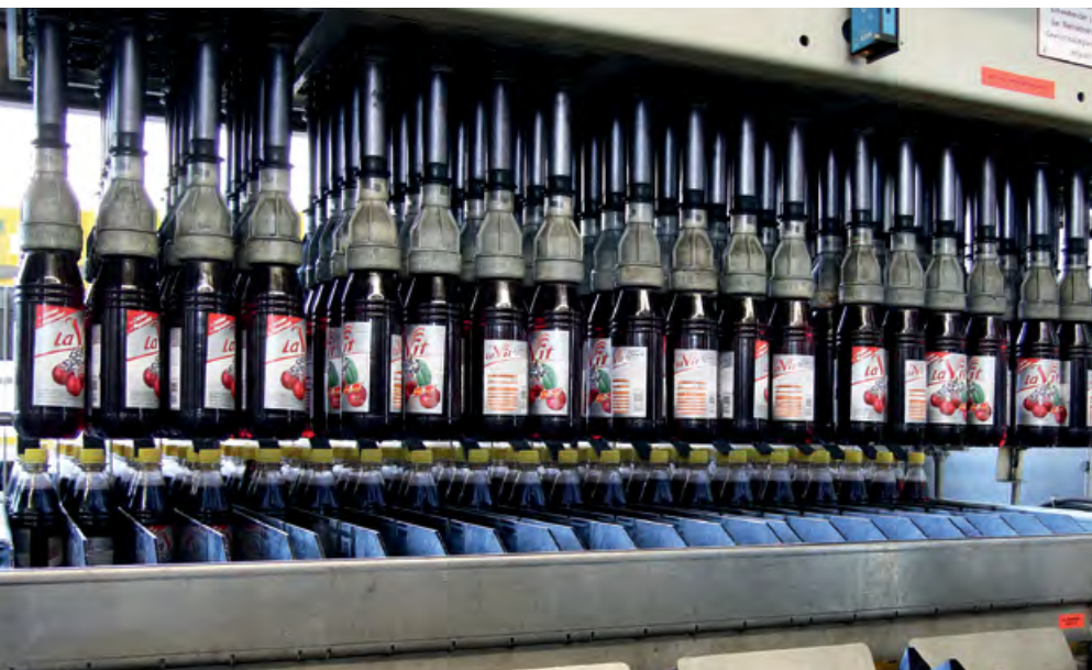
Die Greifstutzen werden mit Druckluft beaufschlagt, verengen sich dadurch und können je 100 frisch befüllte Flaschen am Hals festhalten, um sie in fünf Kästen zu setzen.
