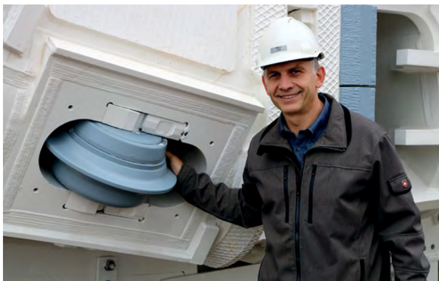
Albert Feißt, Leiter der Fluidtechnik bei Herrenknecht, zeigt einen der Rollenmeißel auf dem 10-m-Bohrkopf der neuen TBM. Rollenmeißel arbeiten wie überdimensionale Glasschneider: Sie lassen harten Stein einfach zerspringen.
