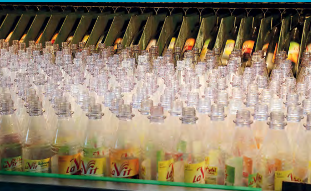
LaVit-PET-Flaschen warten hier auf ihr Laugenbad. Sie werden darin abetikettiert, dann gewaschen und gespült, geprüft, eventuell noch einmal nachgesäubert oder ausgeschossen.
