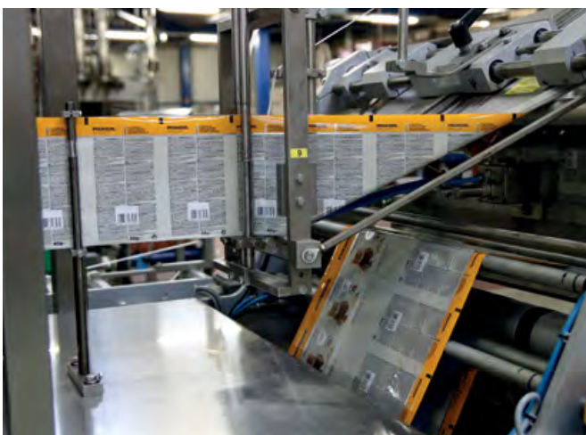
Die Verpackungsmaschine zieht die Folie von einer „Endlos“-Rolle ein und formt sie zu sogenannten Standbodenbeuteln.
